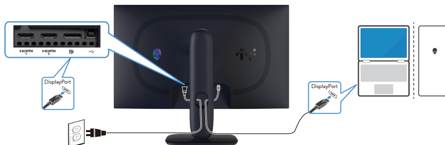
Figura 8. Conectar el cable DisplayPort (DP a DP)
