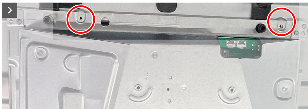
Figura 26. Instalar la protección metálica
