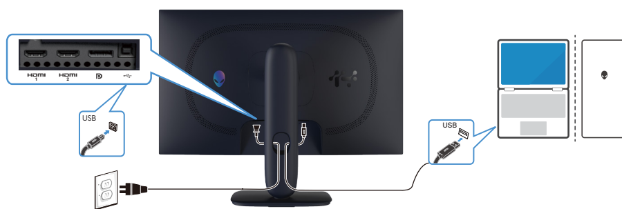
Figura 10. Conectar el cable USB Tipo-B (Tipo-B a Tipo-A)
