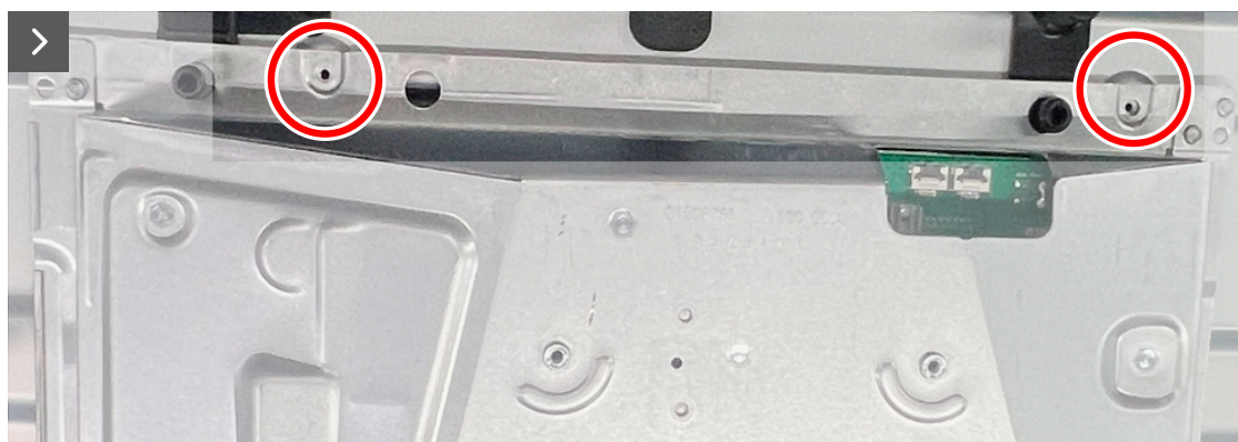
Figura 22. Quitar la protección metálica
