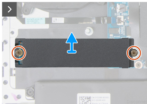
Ilustración 29. Extracción de la SSD M.2 2280 de la ranura de SSD2
