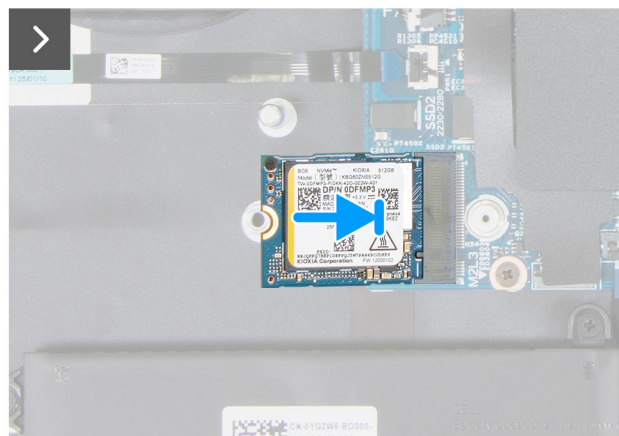
Ilustración 25. Extracción de la SSD M.2 2230 de la ranura de SSD2
