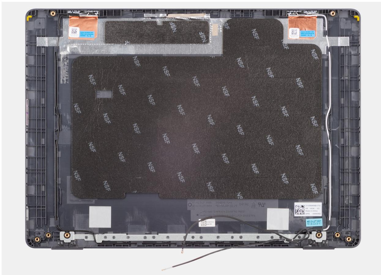
**Ilustración 87. Instalación del ensamblaje de la cubierta posterior de la pantalla**
