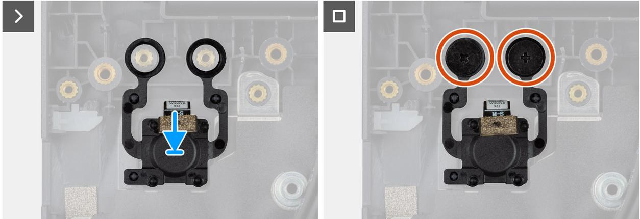
**Ilustración 41. Instalación del botón de encendido con un lector de huellas digitales**
