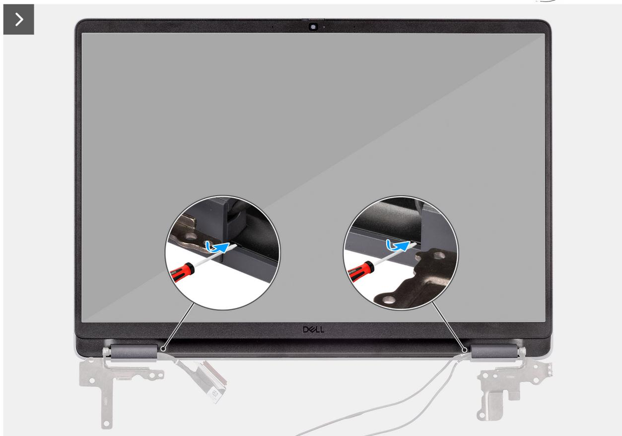
**Ilustración 67. Extracción del embellecedor de la pantalla**
