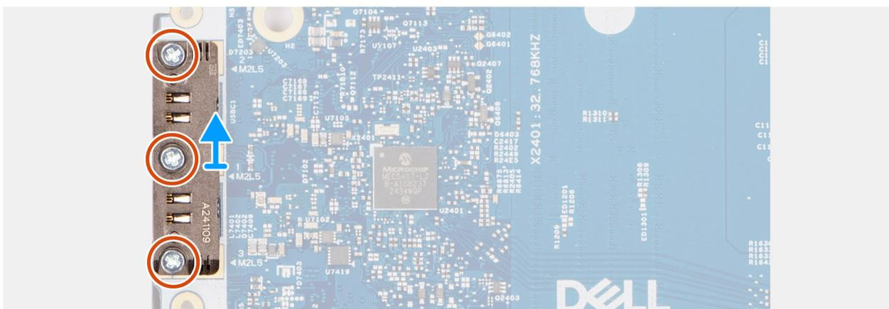
**Ilustración 48. Extracción del módulo USB tipo C**
