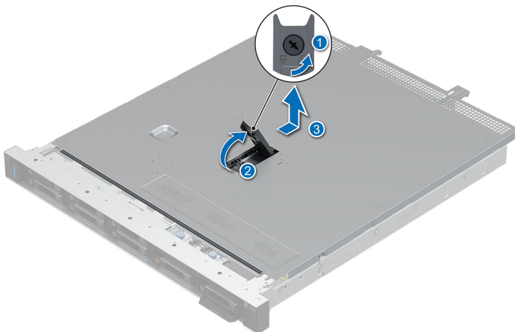
Ilustración 16. Extracción de la cubierta del sistema
