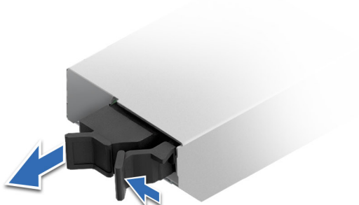
Ilustración 214. Extracción del portaunidades de tarjeta BOSS-N1 DC-MHS de relleno
