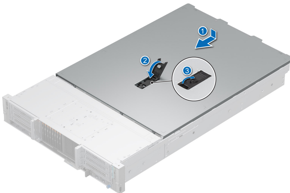
Ilustración 33. Instalación de la cubierta del sistema
