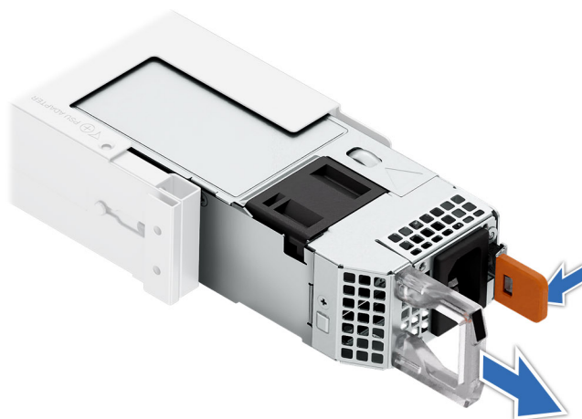
Ilustración 251. Extracción de una fuente de alimentación
