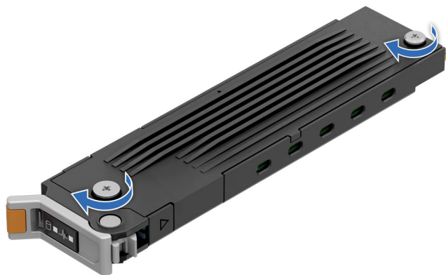
Ilustración 188. Ajuste los tornillos cautivos de la cubierta superior
