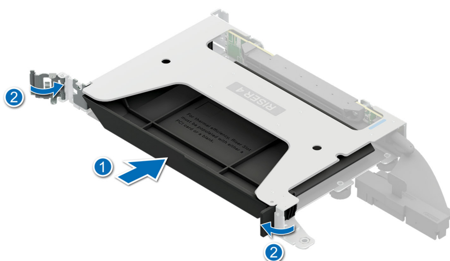
Ilustración 164. Instalación del PCIe de relleno
