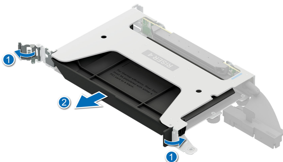
Ilustración 166. Extracción del PCIe de relleno
