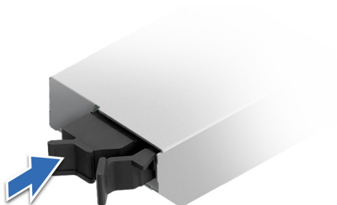
Ilustración 215. Instalación del portaunidades de tarjeta BOSS-N1 DC-MHS de relleno
