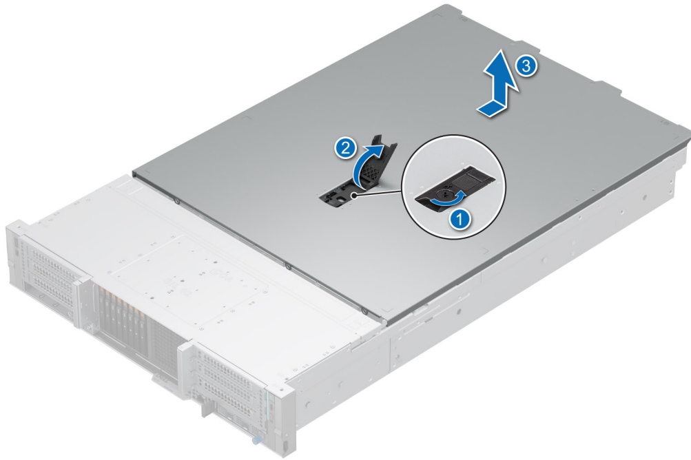
Ilustración 32. Extracción de la cubierta del sistema
