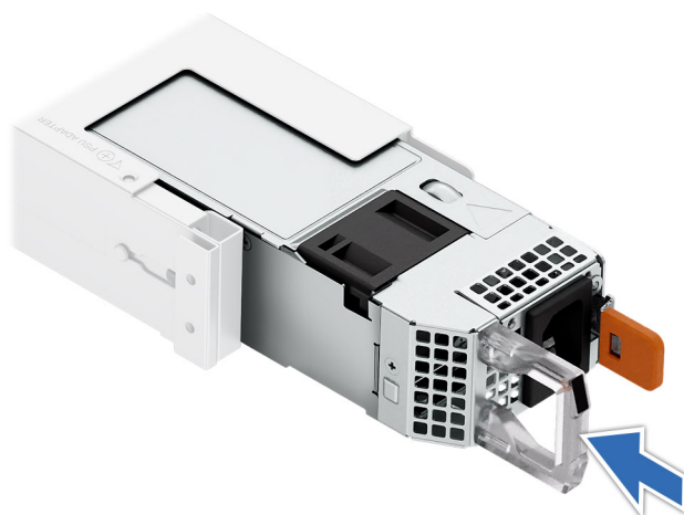
Ilustración 252. Instalación de una fuente de alimentación
