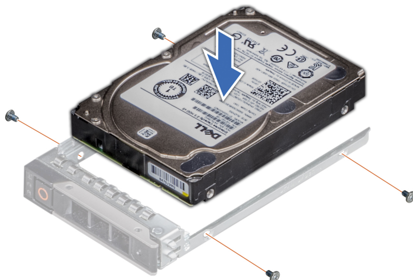
Ilustración 62. Instalación de una unidad en el portaunidades
