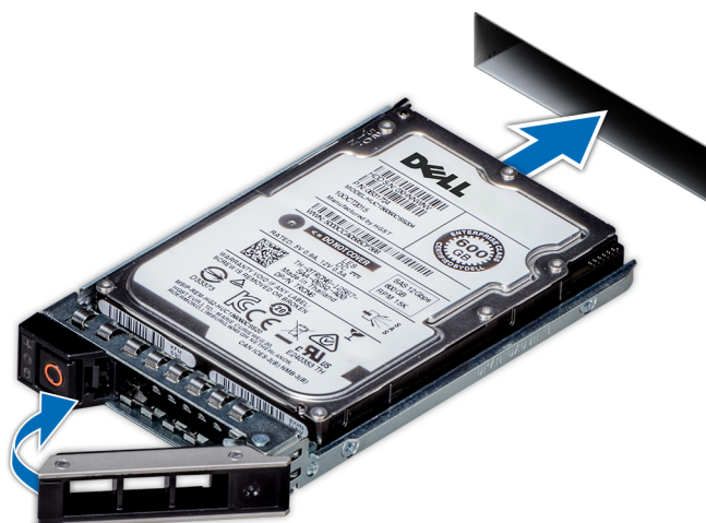
Ilustración 63. Instalación de un portaunidades de disco duro de 3,5 pulgadas
